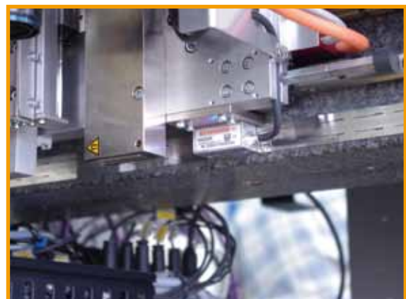
RTL单码道测量钢带插入FASTRACK支撑系统，易于更换，RESOLUTE绝对式光栅还可以安装到空间受限的区域。
