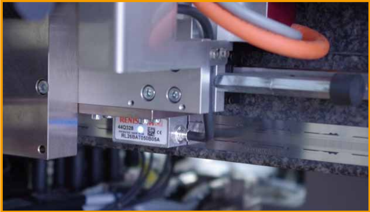
RESOLUTE绝对式读数头上的彩色LED指示灯可直观显示“性能状态检测”，因此简化了调试和序中监测。
