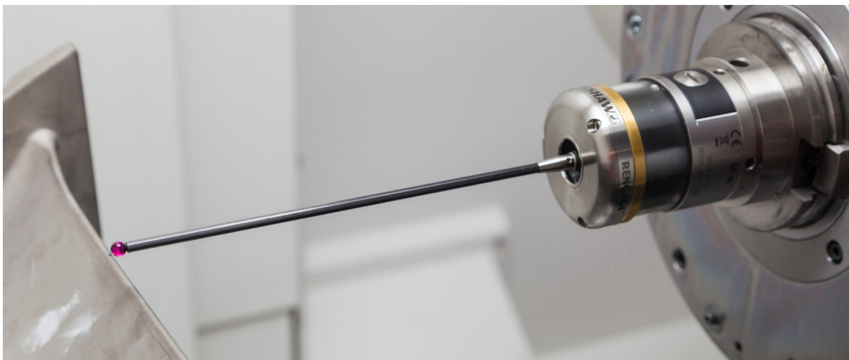
Merilna glava za obdelovalne stroje RMP600 določa položaj aerodinamičnega profila.
