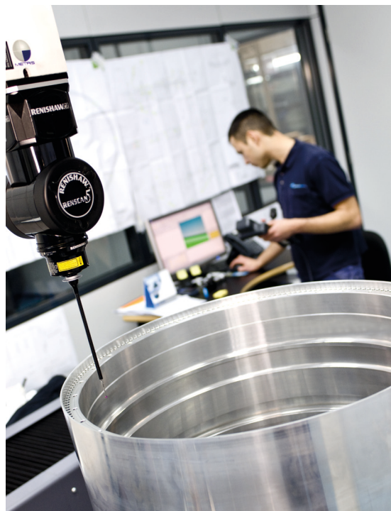
Het REVO systeem scant een grote boring van een onderdeel voor de luchtvaart
